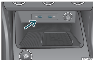
Fig. 137 Centre console: USB port.
